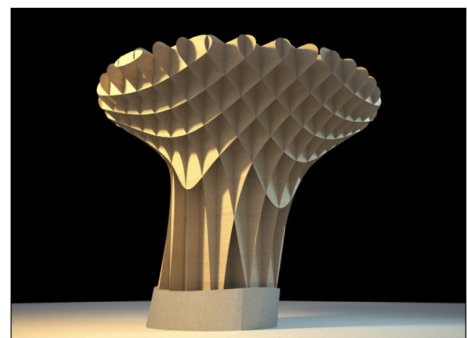
Volumen in einem orthogonalen Raster schneiden und die Polygonen mit einem geringen Wert extrudieren.
